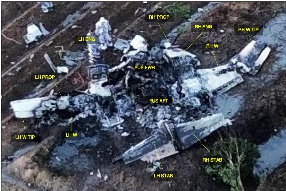
Imagen No. 4 – Ubicación de componentes principales en los restos N325FA (Fuente: DIACC)
