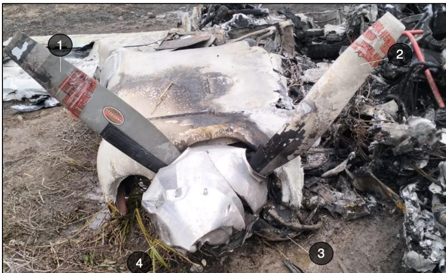
Imagen No. 8 – Condición de la hélice derecha en los restos N325FA (Fuente: DIACC)
