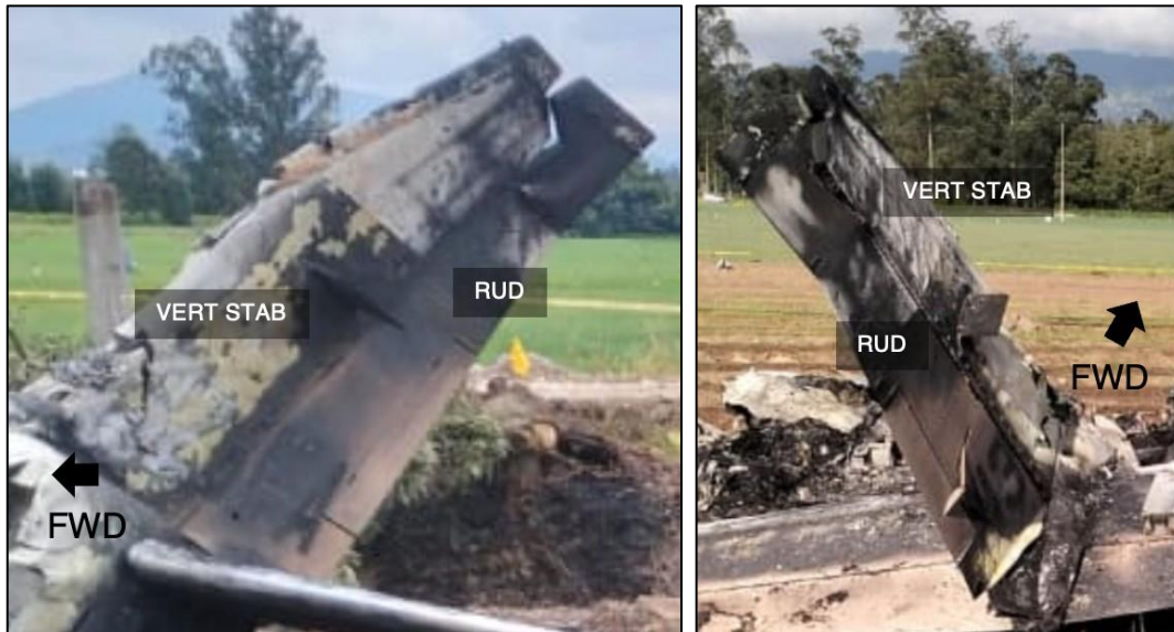
Imagen No. 14 y 15 – Condición de estabilizador vertical N325FA (Fuente: DIACC)
