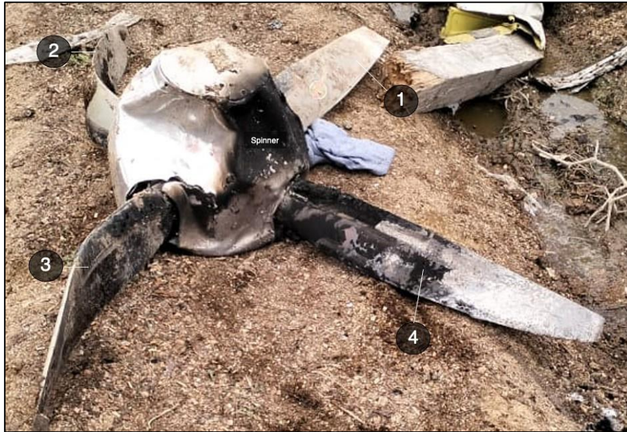
Imagen No. 9 – Condición de la hélice izquierda después de removida de los restos N325FA (Fuente: DIACC)
