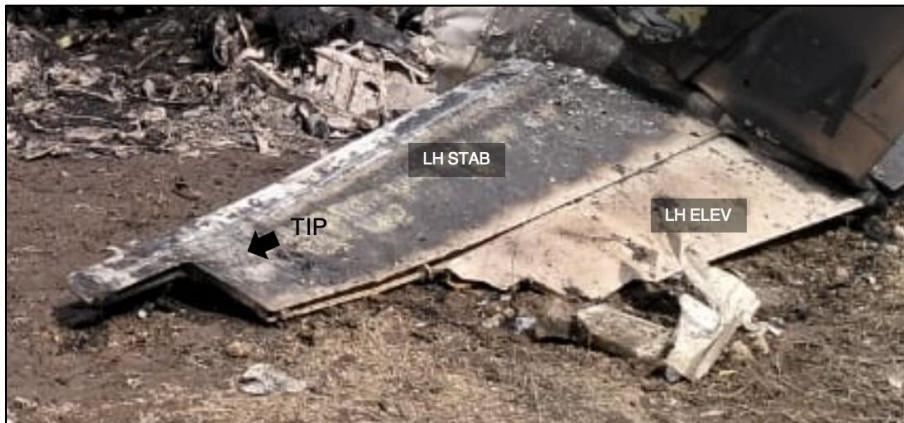
Imagen No. 10 – Condición de estabilizador y elevador izquierdo N325FA (Fuente: DIACC)
